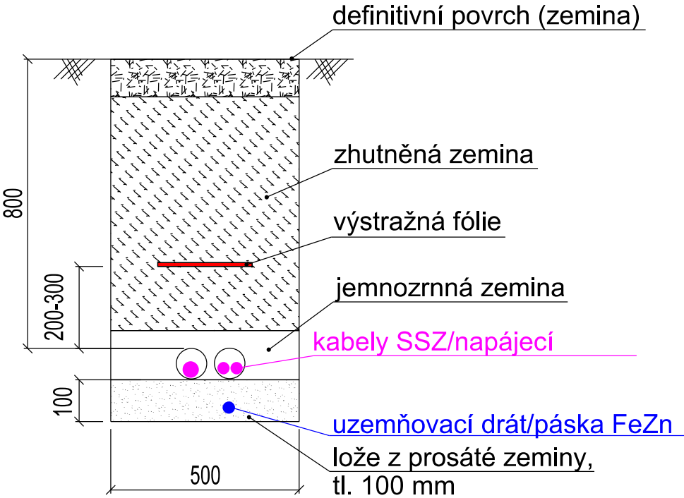
1 Uložení kabelů v nezpevněném terénu
